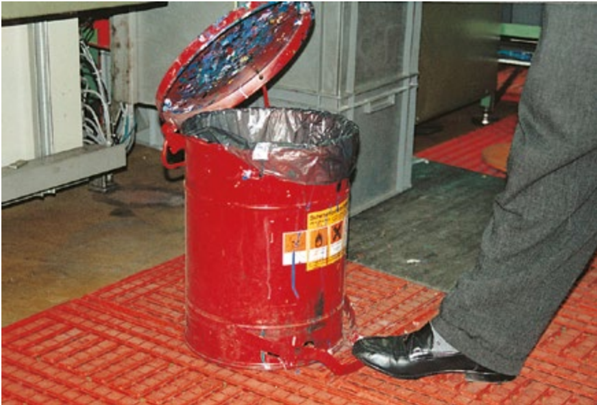
Abb. 39 Sammelbehälter für Putzlappen
